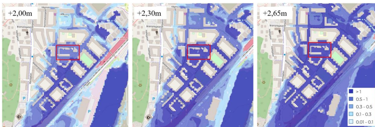
Figur 11 Bilden visar hur högvattennivå i Göta Älv och höga flöden i Kvilebäcken översvämmar området.
